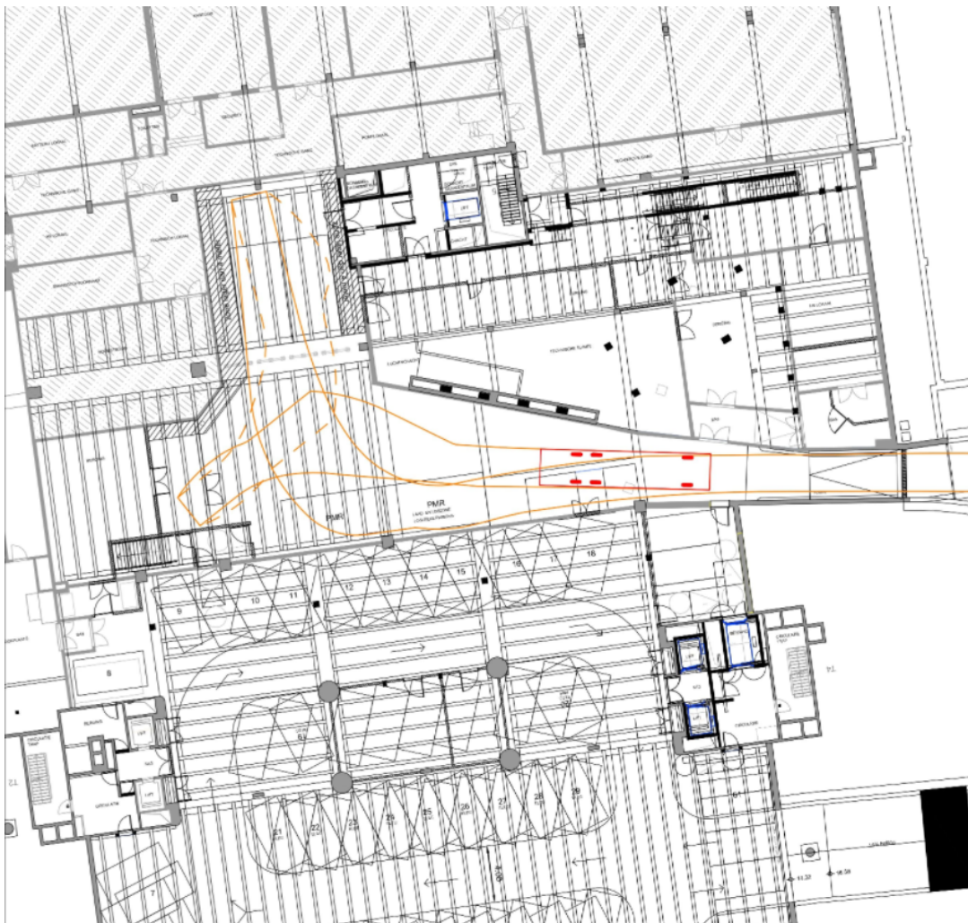
Bovenstaande afbeelding illustreert de draibeweging van een 12m lange vrachtwagen in het logistiek gedeelte van ICC (noordelijk gedeelte van de kelder) binnen de context van deze huidige aanvraag.
