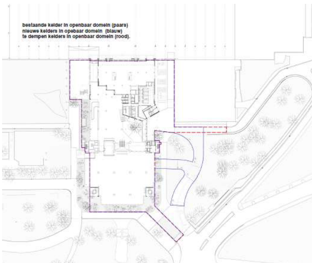
Figuur 11 : bestaande kelder, nieuwe kelder en te dempen kelder
